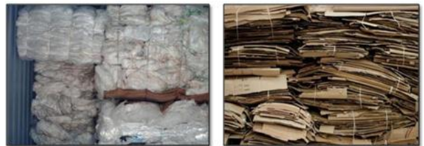
建筑包装物分类收集，集中堆放
