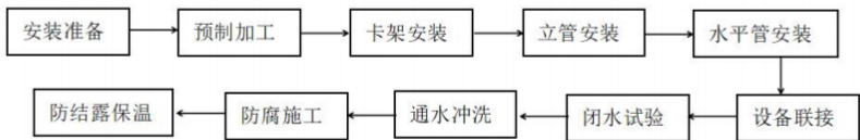
图 7.0.10 冷凝水管道与附件安装工艺流程图
