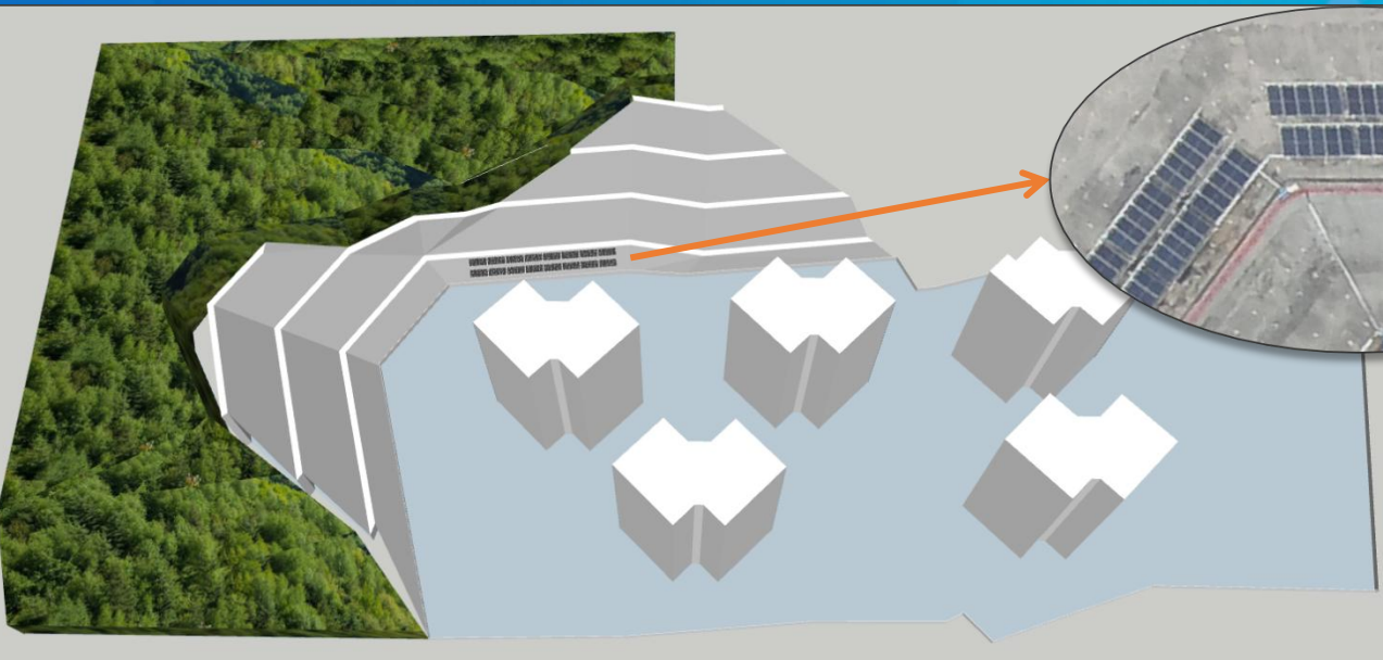
坡地光伏组件排布平面布置图
