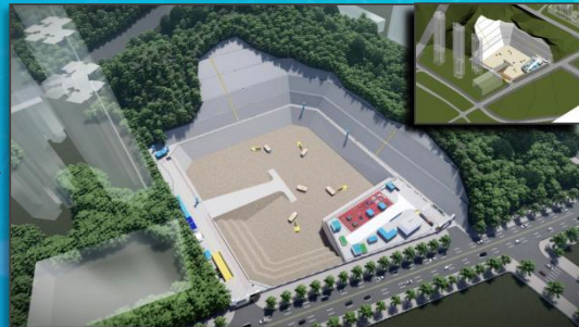
基坑土方开挖及支护施工阶段
