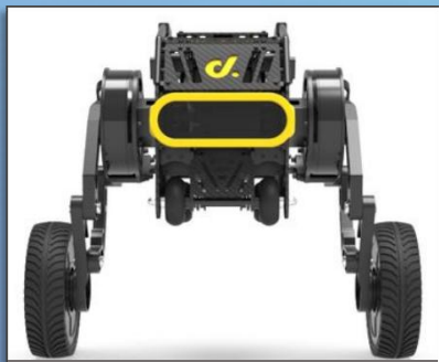
智能巡检机器人 室内无人自主巡查采集
