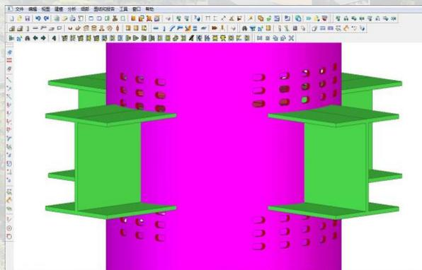
钢梁与圆管柱连接节点深化
