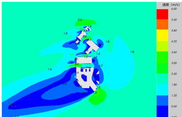
冬季1.5m平面高度风速原始云图
