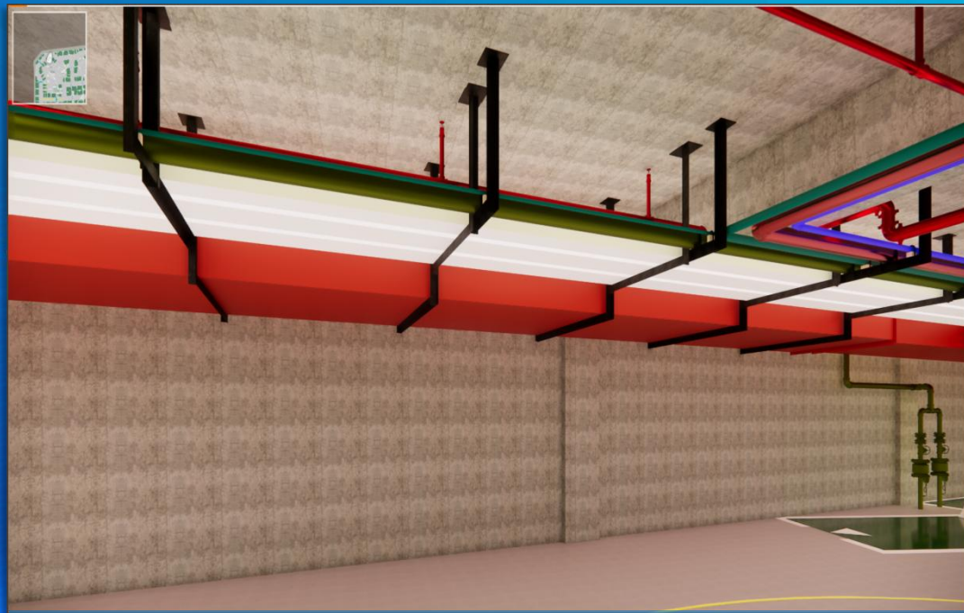
综合支吊架三维可视化
