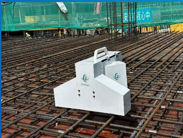
钢筋绑扎机器人
