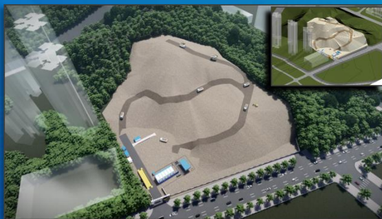
山体边坡开挖及支护阶段
