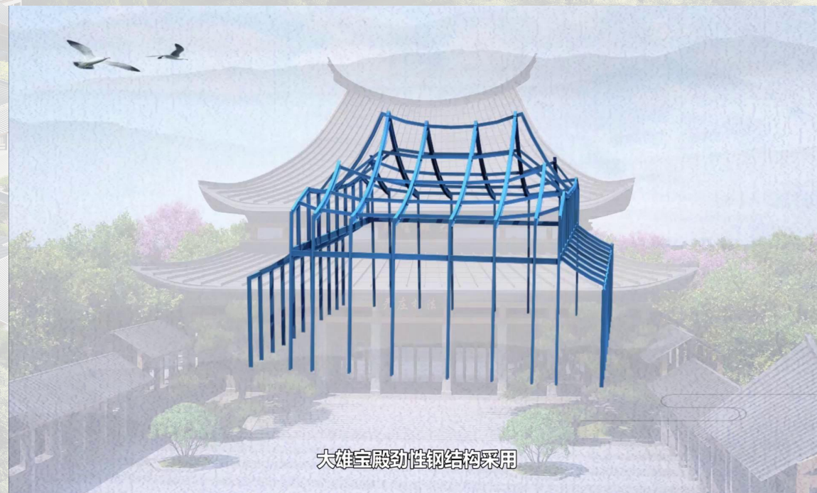
大雄宝殿钢结构安装施工模拟
