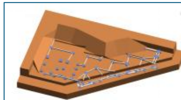
第一步、周边桩基和地梁
